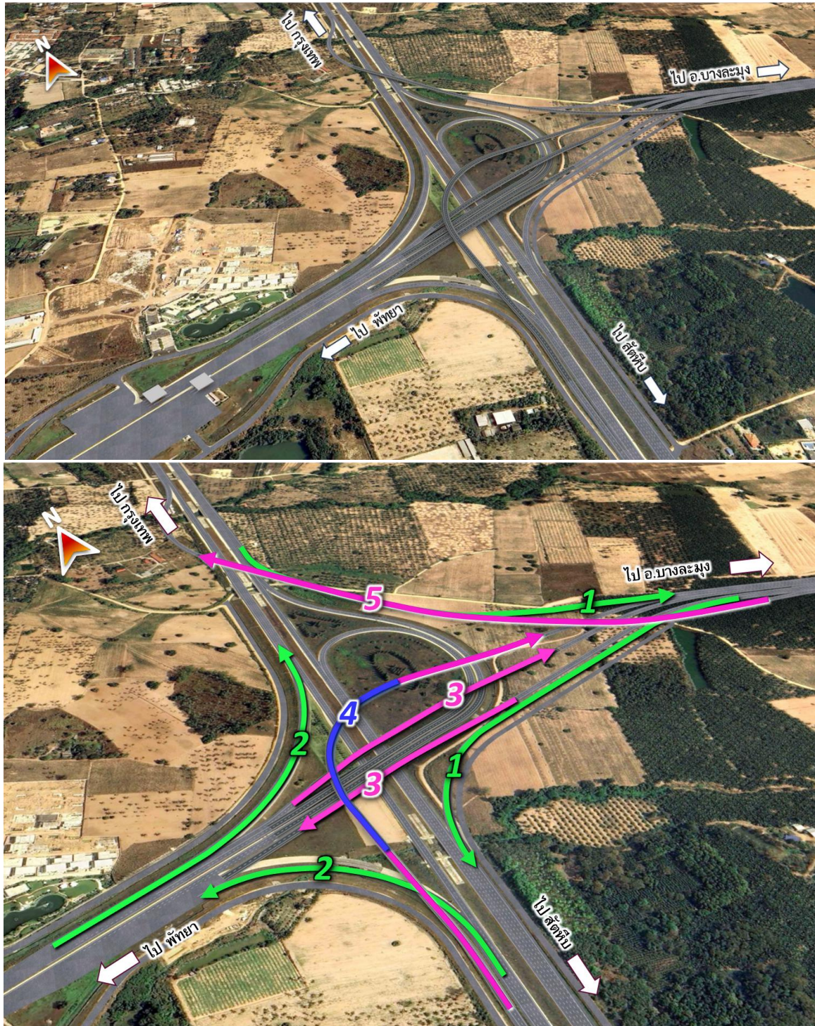
รูปที่ 5-5 รูปแบบทางแยกต่างระดับห้วยใหญ่ รูปแบบทางแยกต่างระดับแบบเชื่อมโดยตรง (Directional Y-Interchange)
